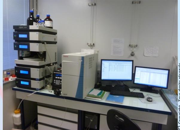
**Légende : Analyses métaboliques :** Appareil de chromatographie liquide haute performance (HPLC) couplé à un spectromètre de masse pour la détection et la quantification de petites molécules.
